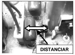
2) Retirar a bobina L501 da placa A e recolocar após colar com o Araldite.
