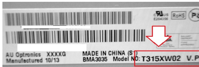
Fig. 8-3. Identificação do painel de LCD pela etiqueta colada no verso (parte interna).
