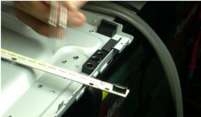
**5.- Coloque la Soldadura en Pasta adecuada al área que va a soldar.**
