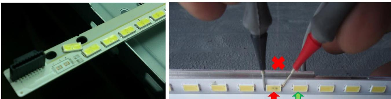
3.- Remueva el LEDs utilizando la pistola de aire caliente (aprox. 340 ° c).
