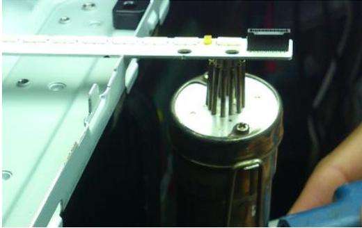
8.- Con la pinzeta y el multímetro asegúrese que el o los componentes hayan quedado ubicados y soldados correctamente.
