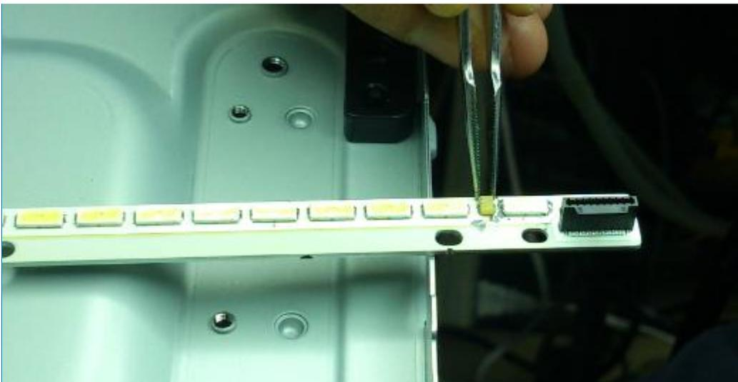
7.- Ya orientado adecuadamente el componente, inicie con el soldado del o los componentes. (aprox. 340 ° c)
