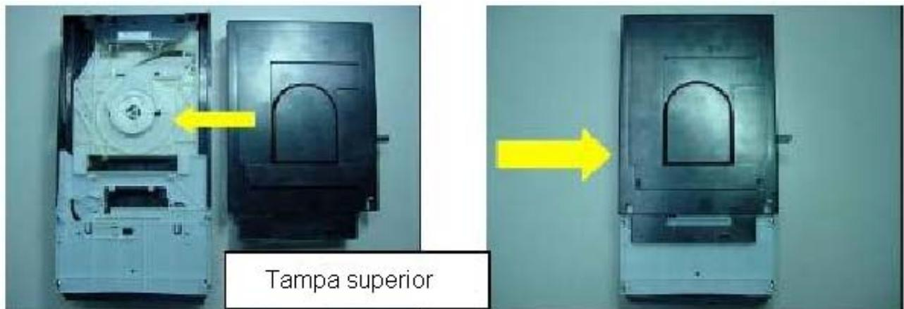
Coloque os parafusos "SCREW + BVTP 3x8" na tampa superior (DUST COVER TOP).(Fig.2.2)
