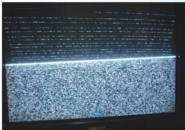
Este defeito é causado pelo diodo D452- BA158. Em medições realizadas nos pinos do Ci TDA4865AJ foi constatado baixa tensão no pino 3. Feito a Substituição por um IN4007 o aparelho voltou a funcionar perfeitamente.
