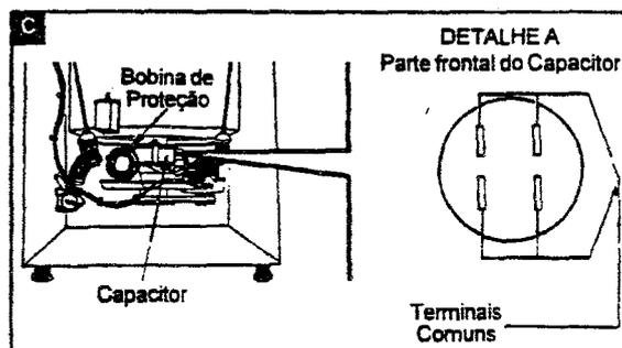
**Obs.:** O Capacitor tem quatro (04) terminais, sendo que dois (02) são comuns. Portanto atente quando da ligação dos fios e nunca ligue os fios nos terminais comuns. (ver detalhe A da figura acima).
