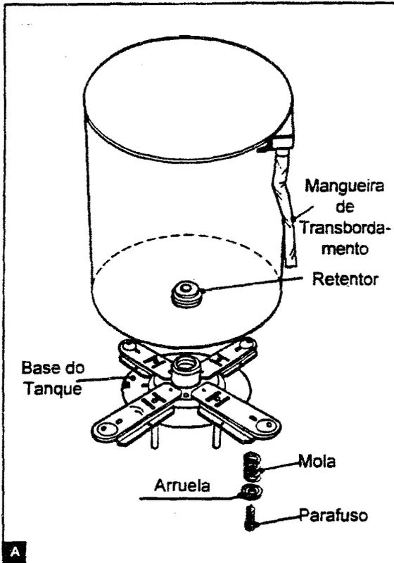
A mangueira de transbordamento é encaixada ao tanque e imobilizada pelo anel hidro compensador. O tanque, por sua vez, é fixo num retentor na base e em quatro pontos, através de moia, arruela e parafuso.
