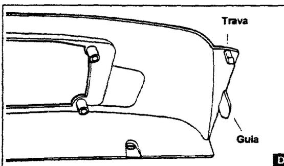
A parte traseira do console é fixa num fundo protetor (fig. E da pag. seguinte) por 2 parafusos sextavados de 5/16". Na tampa do gabinete da lavadora ele fixa-se por meio de 2 travas plásticas e 2 guias injetados em seu próprio corpo.
