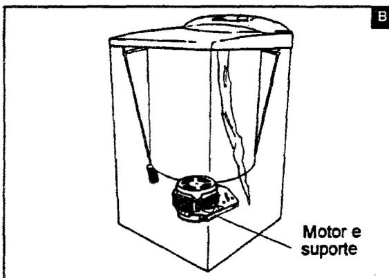
Durante o processo de agitação, o motor inverte continuamente seu sentido de rotação, comandado pelo controle eletrônico. Na centrifugação, sua rotação ocorre somente no sentido horário.
