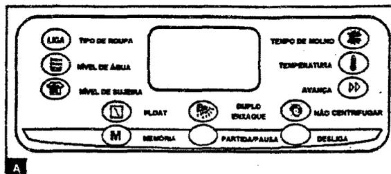
A cada acionamento das teclas, o timer eletrônico emite um BIP. Serão emitidos 03 BIP's consecutivos em caso de acionamento incorreto ou nas condições mencionadas a seguir, porém em intervalos de 05 segundos, durante um período de 20 minutos. Após este período a lavadora desliga-se automaticamente.
