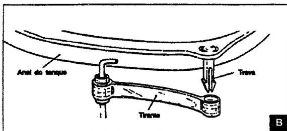
A finalidade dos tirantes é amortecer o movimento do conjunto tanque/ mecanismo na frenagem (final da centrifugação).
