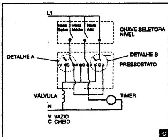
Quando o contato fechado do pressostato coincidir com o da chave do seletor (detalhe B) é interrompida a entrada de água.
