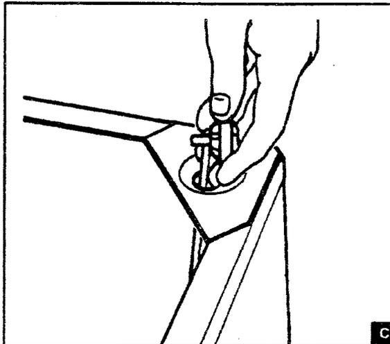
Posicione a mão ou alicate de pressão e incline a trava, fazendo com que a parte vazada desta coincida com a dobra da vara de suspensão.
