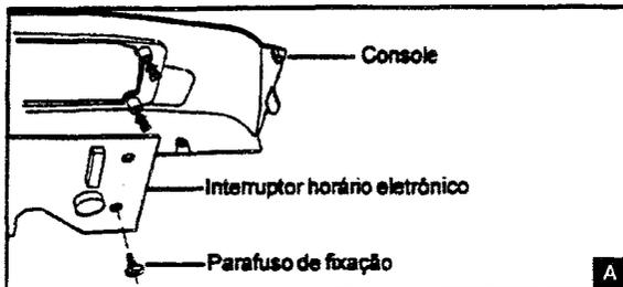
Este interruptor é parte integrante do conjunto formado pela membrana, visor e placa eletrônica. Quando um componente apresenta falha, todo o conjunto deve ser substituído. O interruptor vai conectado no visor de cristal líquido por uma membrana de borracha condutora (fig. B). Esta membrana possibilita a seleção das opções de lavagem e vai colada no painel de controles.
