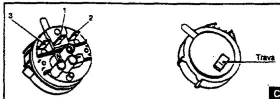
O pressostato abaixo (fig. D) passou a substituir o ilustrado na figura acima (fig. C), a partir de março de 1994, sendo totalmente intercambiável com ele.
