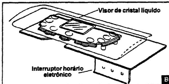
Colada no painel de controles por uma película de alumínio e conectada no interruptor horário por meio de uma fita flexível do tipo *Flat Cable*, a membrana possibilita a seleção das opções de lavagem do produto.
